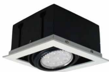
AR111有邊框嵌燈 (1燈) 開孔160*160外徑184 高度91MM
