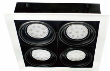
AR111有邊框嵌燈 (4燈) 開孔306*306外徑352 高度85MM
